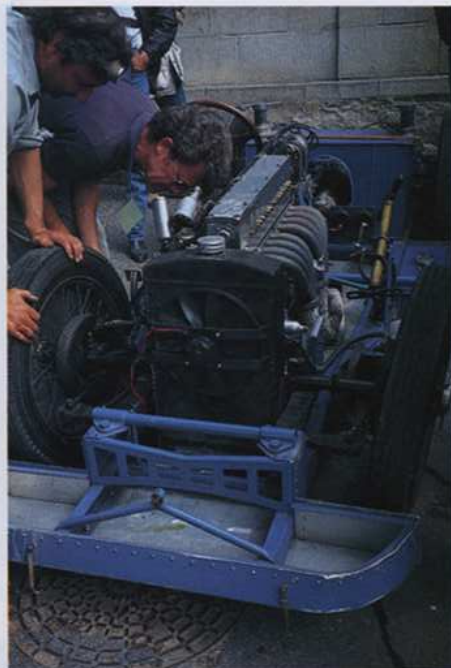
パドックでボディを外して応急修理するサザランドのブガッティ。1/2楕円バネを規制するリーディングアーム取り付け部が壊れた。
