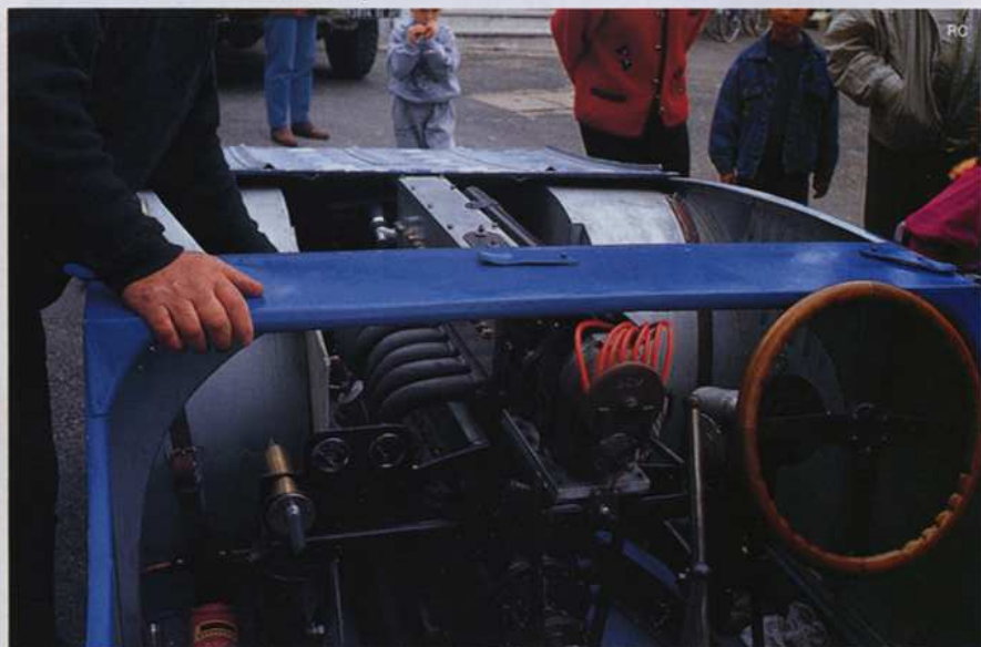
ブガッティ“タンク”にはエンジンとコックピット間の隔壁がない。その騒音と熱の凄まじさ！
