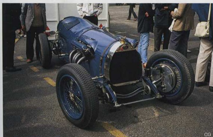
1923年ドラージュGPシャシーに、ムシュー・ベケというフランス人が後にイスパノ・スイザ航空V8エンジンを載せて高性能化を図ったスペシャル。
